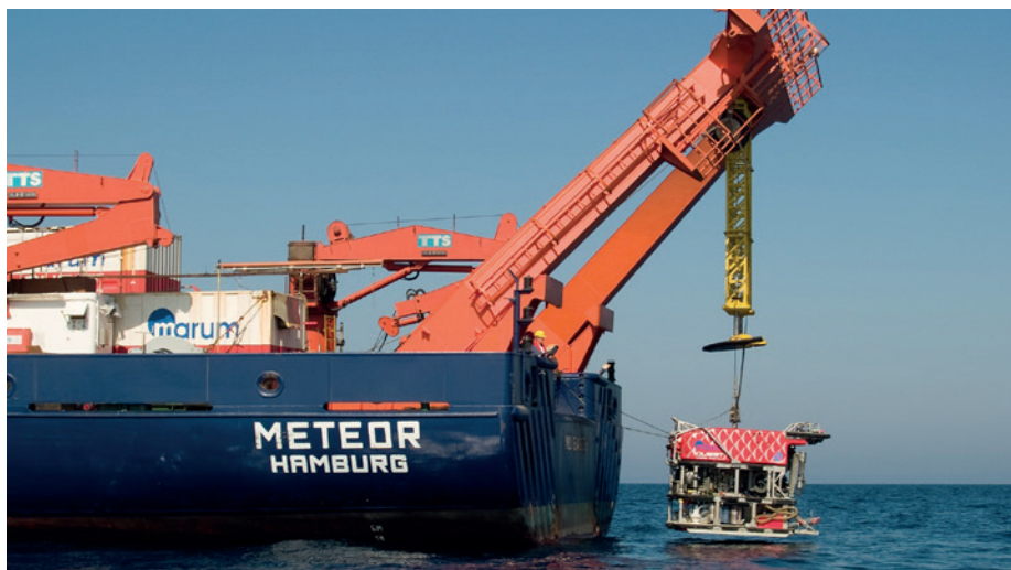
Ein ferngesteuertes Fahrzeug wird von dem Forschungsschiff Meteor aus in die Tiefsee hinabgelassen.
